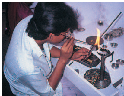
Figura 4.6 Cannello ferruminatorio e fiamma di candela di cera
