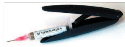
Figura 5.5a Dosatore a mano per pasta di lega per saldatura. (Per gentile concessione di Hilderbrand & Cie. SA)
