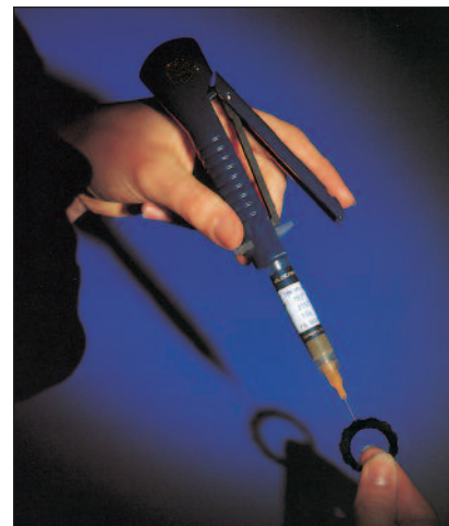
Figura 5.5b Dosatore a mano di pasta di lega per saldatura durante l'uso. (Per gentile concessione di Hilderbrand & Cie. SA)
