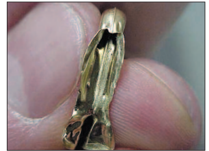
Figura 9.2 Esame di un giunto saldato. (Per gentile concessione di Krohn Industries)
