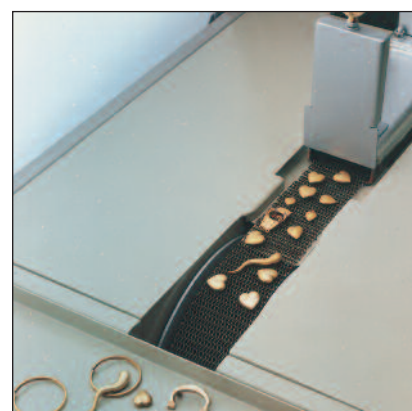
Figura 4.11 Saldatura di pezzi stampati su nastro trasportatore in un forno continuo. (Per gentile concessione della IECO srl, Italia)
