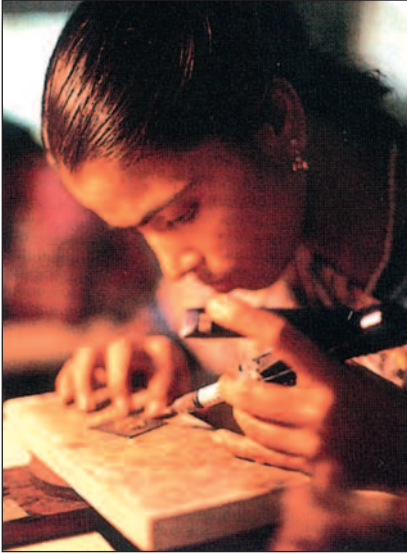
Figura 5.7 Applicazione di pasta di lega per saldatura su gioielleria tradizionale in oro a 22 K
