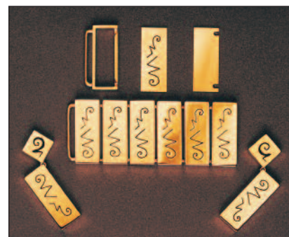
Figura 7.18 Parti di una parure di bracciale e orecchini in oro a 18 K, saldati per diffusione a 450°C
