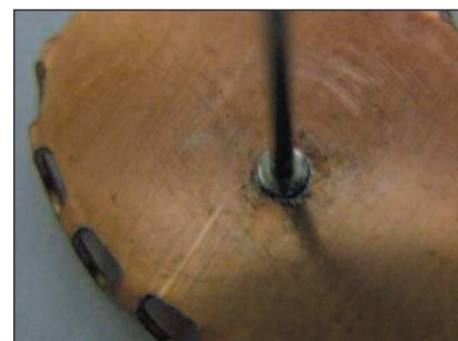
Figura 7.11 Tipica saldatura per fusione con scarica elettrica. (Per gentile concessione di J. Alves)
