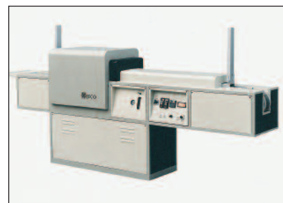
Figura 4.10 Tipico forno continuo a nastro. (Per gentile concessione della IECO srl, Italia)
