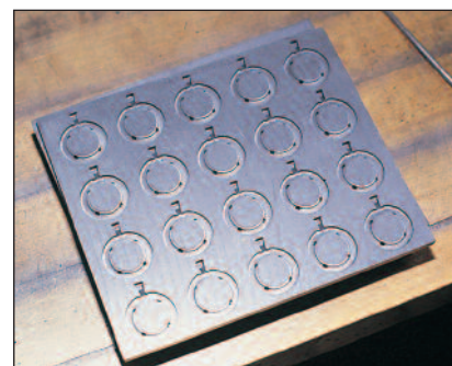
Figura 4.5 a Piastrina di grafite lavorata con macchina CNC
