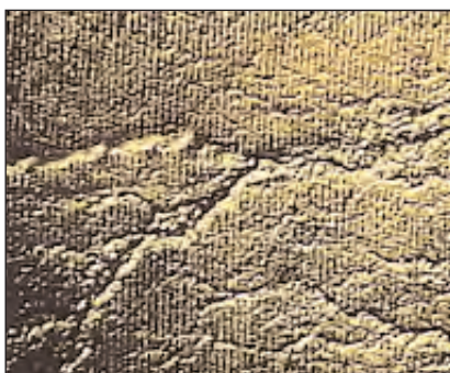
Fig. 8.2 Ondulazioni su un provino (parte di un disco). Circa 10x
