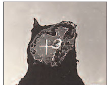
Fig. 13.4 Inclusionione di scoria con bordi arrotondati, che suggerisce l'idea che probabilmente al momento del colaggio la particella era liquida
