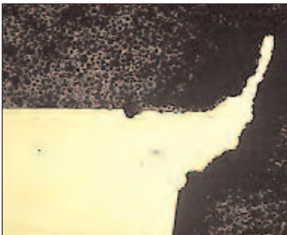
Fig. 7.3 Sezione del bordo di un pezzo con bave. 50x
