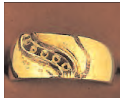
Fig. 12.1 Porosità superficiale causata da impurezze
