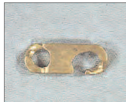
Fig. 14.1 Gancio a molla con porosità superficiale
