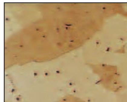
Fig. 26.3 Cassa per orologio, stampata a freddo e ricotta (650°C, 30 min.). 200x
