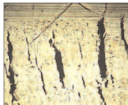
Fig. 15.1 Superficie dell'anello. Circa 20x
