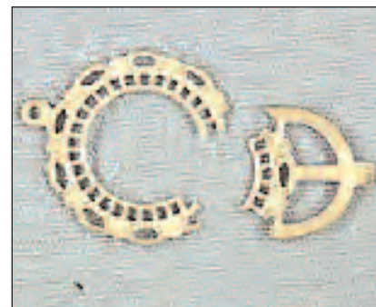
Fig. 17.8 Ciondolo, rotto dopo la rimozione del refrattario
